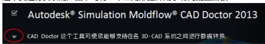
单击产品框中的任意位置以打开配置面板。对于许多产品，您可以选择安装类型，或者选择“典型”以接受默认配置设置，或者选择“自定义”以查看设置，并确定是否对其进行修改。有关适用于您的产品的配置设置详细信息可能存在于本手册的附录中。根据需要配置设置后，单击三角形以关闭配置面板。
